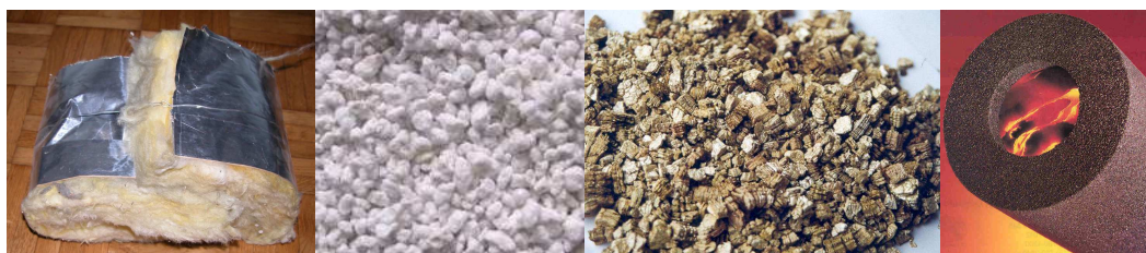
Matériaux isolants à base de matières minérales. De gauche à droite: Laine de verre, perlite, vermiculite, verre cellulaire Source : De gauche à droite: VIBE vzw, www.travellersgarden.vom , Foamglas
