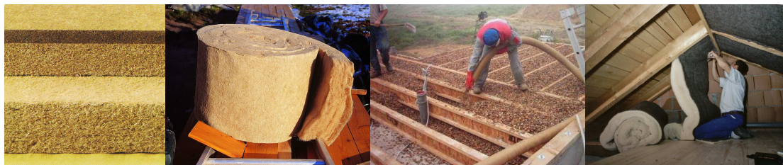
Matériaux d'isolation à base de laine végétale ou animale. De gauche à droite : Fibres de bois, lin, chanvre, laine de mouton.
